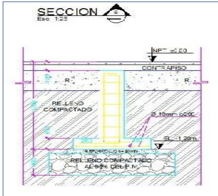
Figura 5. Sección de Relleno y Contrapiso
