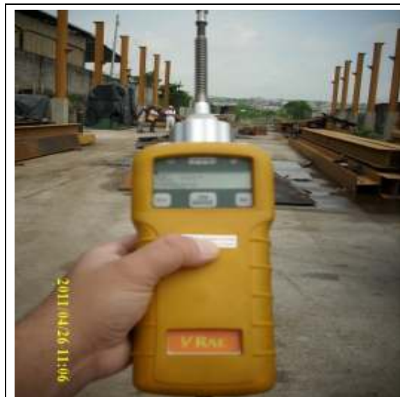
Fotografía 1. EAR1 - Equipo de monitoreo de Gases de combustión y material particulado en el Centro del Predio.
